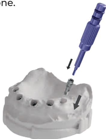
INNESTO E SERRAGGIO DEL MONTATORE NELL'ANALOGO
